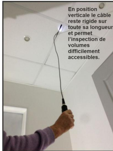
Poignée-émetteur avec capteur en bout de câble amovible
