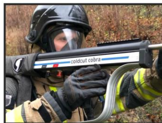
La nouvelle lance Cobra et une lance à système d'entraînement avec son réservoir de 2 k d'abrasif
