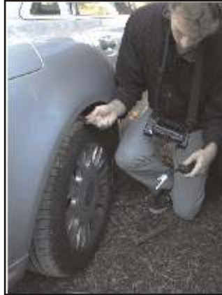
En position verticale le câble reste rigide sur toute sa longueur et permet l'inspection de volumes difficilement accessibles.
