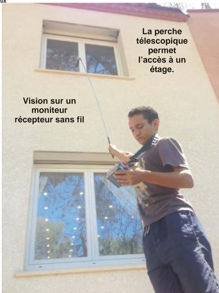
20 mm de diamètre, 33 Gr et 86 mm de longueur : la caméra peut-être utilisée sans perche, avec ou sans éclairage.
