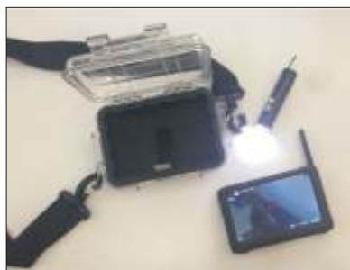
Le moniteur-récepteur-enregistreur peut être visualisé tel quel ou protégé dans un boîtier étanche et anti-choc ou sur un support de poignet (en option).
