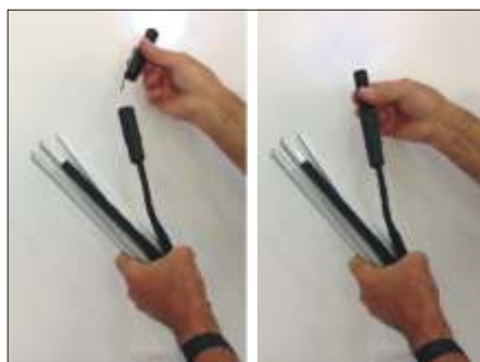
Avec son émetteur et sa batterie intégrés la caméra se positionne en 2 secondes en bout de perche.
