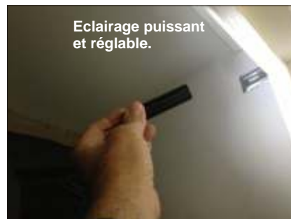
20 mm de diamètre, 33 Gr et 86 mm de longueur : la caméra peut-être utilisée sans perche, avec ou sans éclairage.
