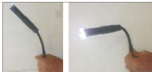
La dernière section qui supporte la caméra est à mémoire de forme pour une pré-orientation avant l'exploration.
