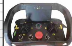
La télécommande pilote le robot et le moniteur.
