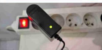
Pour charger la batterie brancher le chargeur sur le secteur puis le connecteur sur la prise de charge derrière l'écran. La batterie est chargée quand le voyant du chargeur passe au vert.
