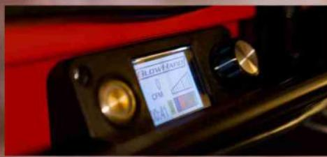
Panneau de contrôle : affichage permanent du niveau de batterie. Passage automatique de l'alimentation batterie/secteur.
