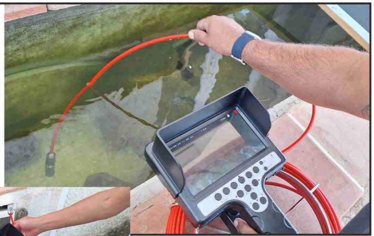
Un simple bouton permet de passer d'une caméra à l'autre.
