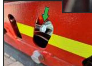
Ecrou de réglage de la tension de la chenille vu de l'intérieur ci-dessus et vu de l'extérieur à gauche.
