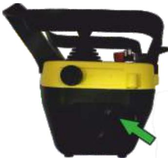
Mettez le Rover en marche, déverrouillez le bouton STOP de la télécommande puis appuyez deux fois sur le bouton latéral de la télécommande avec un intervalle d'une demi seconde.
