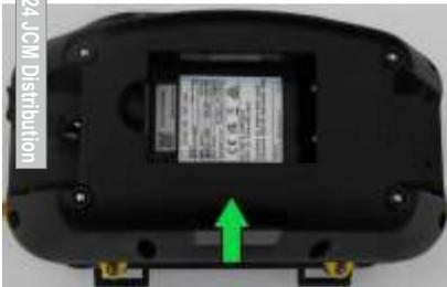
Après avoir enfoncé le bouton STOP de la télécommande, retirez le couvercle arrière et insérez la batterie dans son compartiment.
