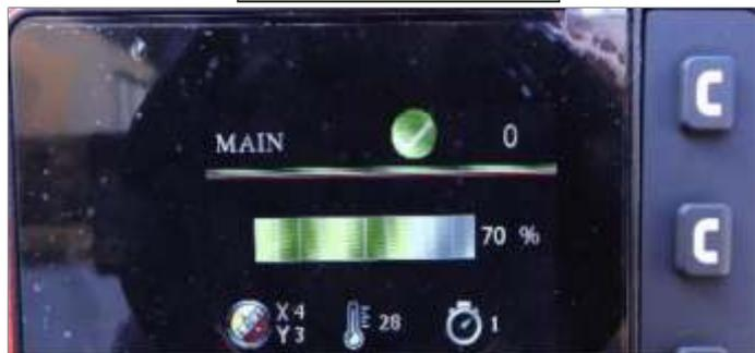
Affichage du niveau d'inclinaison du Rover. En cas de dévers excessif la led arrière rouge clignote et l'écran affiche une erreur d'inclinaison excessive..
