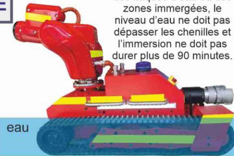
En cas d'évolution dans des flaques d'eau ou des zones immergées, le niveau d'eau ne doit pas dépasser les chenilles et l'immersion ne doit pas durer plus de 90 minutes.
