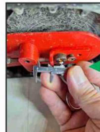
Mesurez précisément l'écartement qui doit être identique de chaque côté de la roue avant de resserrer l'axe de la roue.
