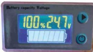
A l'arrière du robot ce voyant indique le niveau de charge de la batterie du robot.
