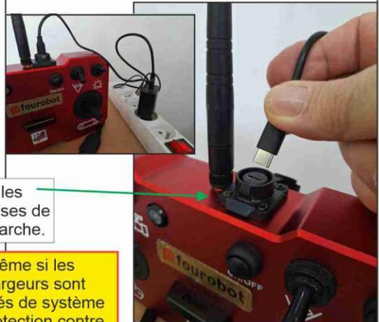
Au dessus de la télécommande, connexion du chargeur.
