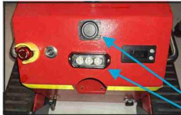
Si la température intérieure dépasse 60°C, déclenchement d'une alarme sonore et visuelle...
