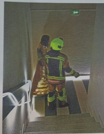
Le câble éclairant Mamba permet d'assurer l'évacuation sécurisée d'une cage d'escalier privée d'éclairage. Les Mamba éclairants sont conçus pour se rabouter les uns aux autres permettant d'allonger le dispositif jusqu'à 75 m.
