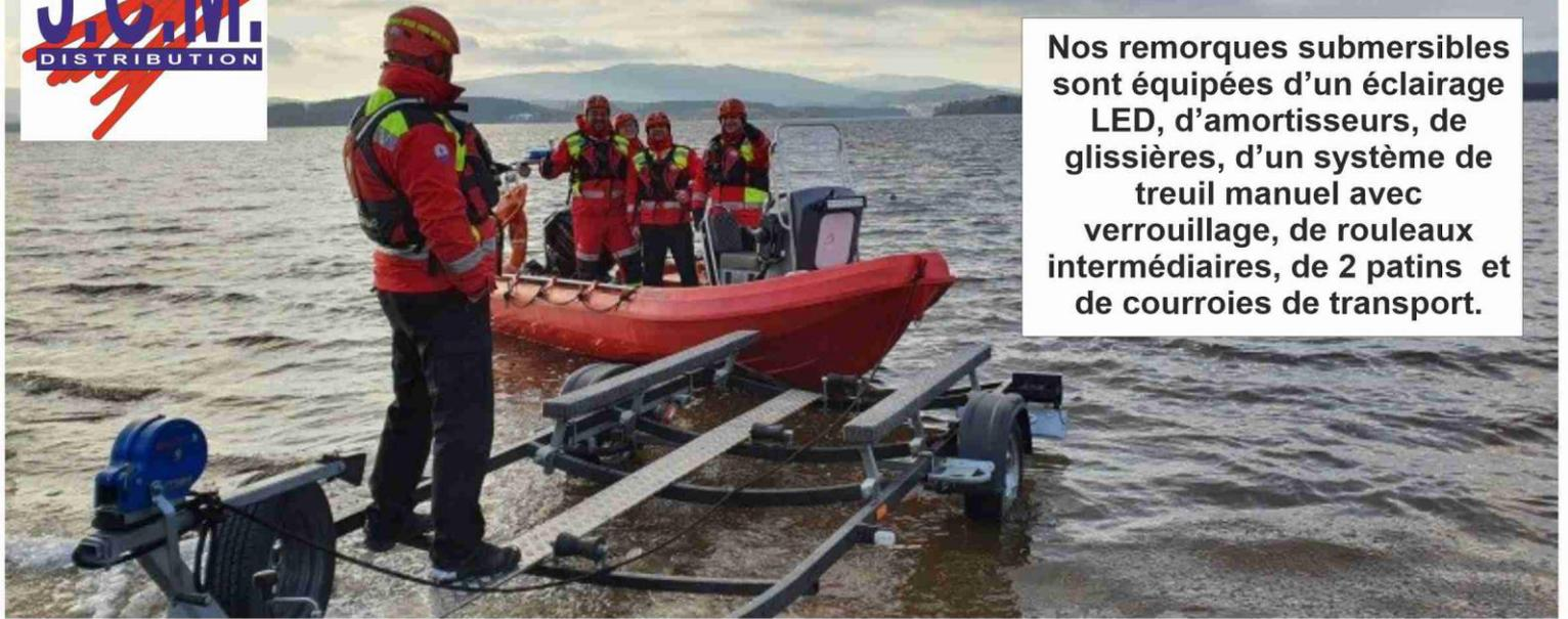
Nos remorques submersibles sont équipées d'un éclairage LED, d'amortisseurs, de glissières, d'un système de treuil manuel avec verrouillage, de rouleaux intermédiaires, de 2 patins et de courroies de transport.
