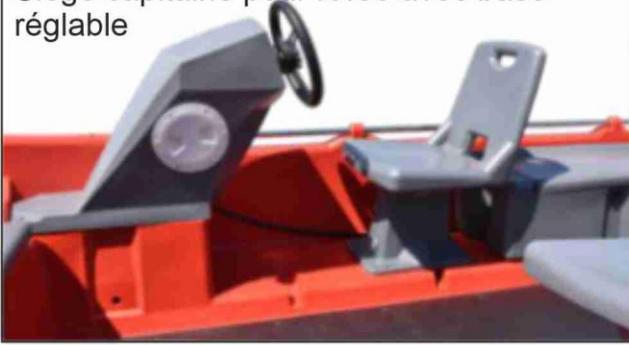
Console de pilotage avec volant, siège, transmission, prise électrique et USB.
