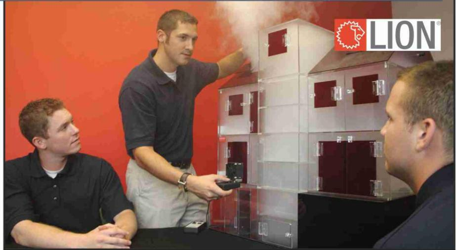
Enseignez les applications et les limitations de la ventilation à pression positive avec le PPV Trainer. Ce système modulaire compact permet de visualiser le comportement de la fumée dans les bâtiments et apprend aux stagiaires ce qu'ils doivent faire en cas d'accumulation de fumée.
