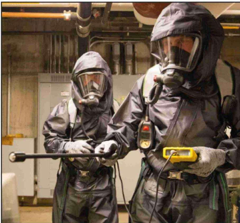
**Polyvalent** : identification des émissions électroniques de quatre types de gaz différents
