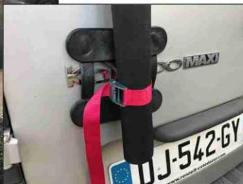
Le placche magnetiche si adattano al rilievo del corpo
