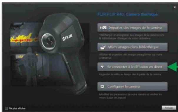
Pour la diffusion vidéo en direct vous devez connecter la caméra au PC par le câble USB, ouvrir FLIRTOOLS et cliquer sur "Se connecter à la diffusion en direct"
