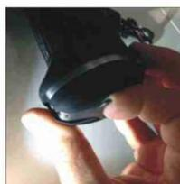
3- Pour retirer la batterie procéder à l'inverse en commençant par soulever le crochet pour débloquer la batterie.
