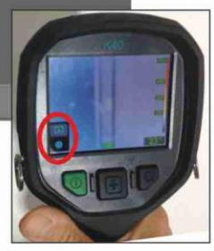
A droite, outre la fonction de base, seule la fonction "détection de points chauds" a été paramétrée.
