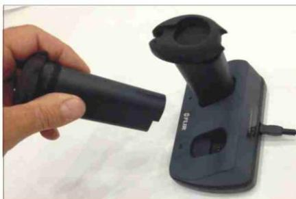
Insérez les deux batteries dans le socle de charge.
