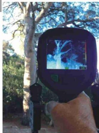
Presser le bouton vert pendant 2 à 3 secondes. Si la caméra était éteinte (par exemple avec ses batteries en charge) la mise en marche prend une vingtaine de secondes. Si la caméra était en veille, la mise en marche prend 4 secondes environ.
