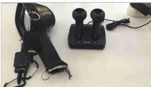
Il est vivement recommandé de toujours laisser les deux batteries en charge afin d'être sûr de disposer de toute leur autonomie au moment de décaler.
