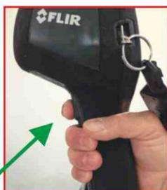
Une seule pression, ferme, sur la gâchette pour prendre une photo. L'affichage d'une icône à gauche de l'écran confirme l'enregistrement de la photo. Sur la K55, si le gel d'image n'a pas été sélectionné, 10 heures de vidéo par séquences de 5 minutes peuvent être enregistrées en maintenant la gâchette enfoncée.
