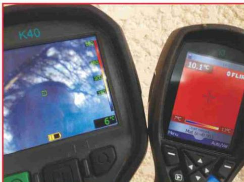
Des écarts de mesure importants peuvent être constatés entre 2 modèles sans que cela soit gênant pour l’opérateur.
