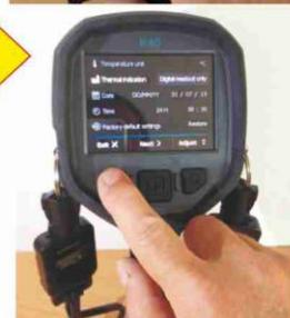
La température affichée est la température moyenne de la ou des surfaces apparaissant derrière le carré au centre de l'écran et comprises dans un cercle dont le diamètre est proportionnel à la distance entre la caméra et la surface visée.
