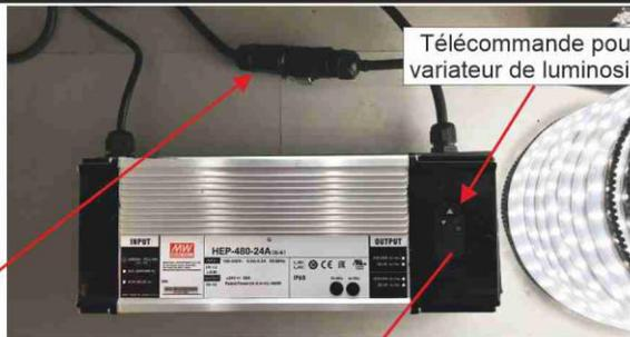
La valise pour batteries Milwaukee (VALBAT) est équipée d'un régulateur intégré et ventilé indispensable pour éviter la surtension constatée avec toutes les batteries pleinement chargées, surtension entraînant une surchauffe des leds, préjudiciable à leur durée de vie.
