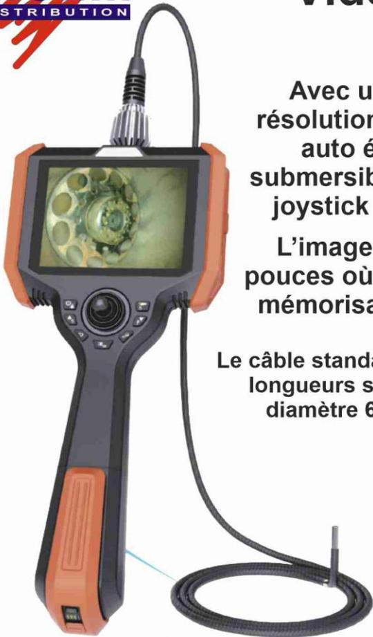
Avec un diamètre de 6 mm mais une résolution d'1 million de pixels, la caméra auto éclairée en bout de son câble submersible est béquillable à 360° avec un joystick manipulable d'une seule main.
