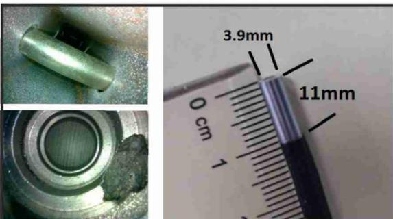
La profondeur de champ du modèle en 3.9 mm est de 5 à 100 mm, idéale pour une inspection rapprochée..
