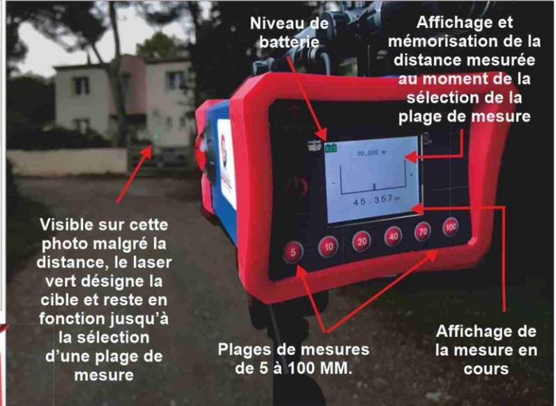
Visible sur cette photo malgré la distance, le laser vert désigne la cible et reste en fonction jusqu'à la sélection d'une plage de mesure
