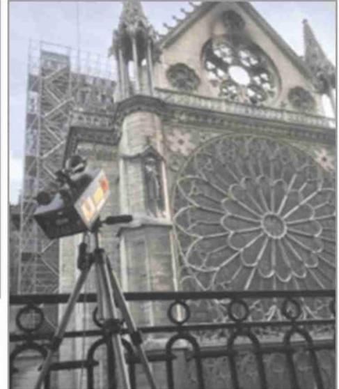
Plusieurs Guardangel -ici le modèle V1- furent positionnés autour de Notre Dame après l'incendie pour identifier les mouvements éventuellement provoqués par la fragilisation des structures.
