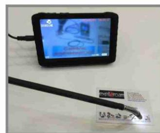
Pour l'exploration simple et efficace de la plupart des volumes. Particulièrement apprécié par les contrôleurs chargés de l'inspection des bouteilles d'air, le capteur haute définition et auto-éclairé de l'Explorcam 7 peut être orienté à plus de 180° vers l'arrière après son introduction dans la bouteille.
