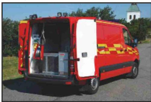
**Le kit C 330 P est un système d'extinction par perçage (28 lpm et 300 bar) avec un moteur à essence à quatre temps, conçu pour une installation basée sur un véhicule et peut être assemblé en tant qu'unité autonome dans la plupart des véhicules sans recours à la boîte de vitesses ou à la transmission de puissance.**
