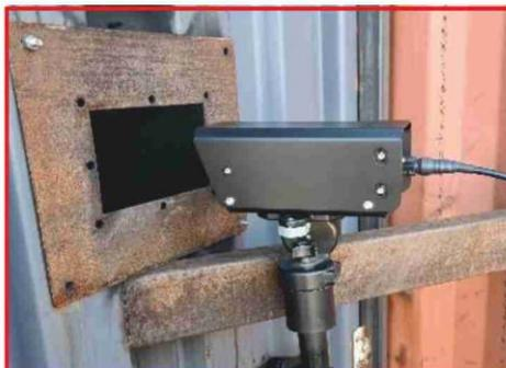
Positionnée sur un support fixe ou mobile, la CAMIR peut rester en permanence à l'extérieur sans souffrir des intempéries, avec une maintenance limitée au nettoyage du hublot de protection.
