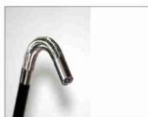
Le segment rigide qui intègre le capteur en bout de câble est le plus court au monde ! Il permet une navigation optimale dans les structures les plus complexes.
