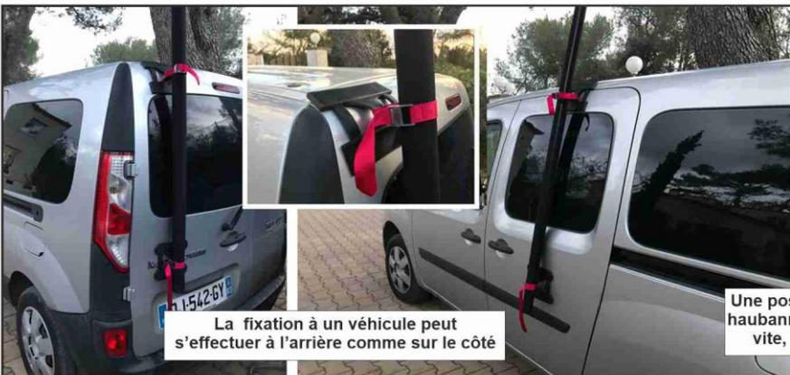
La fixation à un véhicule peut s'effectuer à l'arrière comme sur le côté
