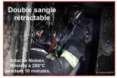
Les deux points de fixation de chaque côté de l'écran permettent le port de la caméra avec deux sangles rétractables qui optimisent le confort de l'utilisateur.
