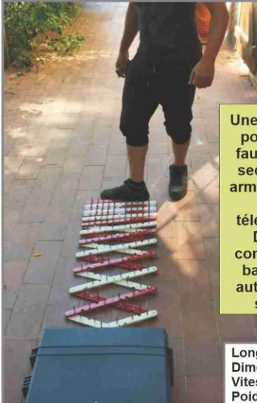
Une fois la valise positionnée, il faut moins de 5 secondes pour armer le système avec la télécommande. Dans cette configuration la batterie a une autonomie de 2 semaines.
