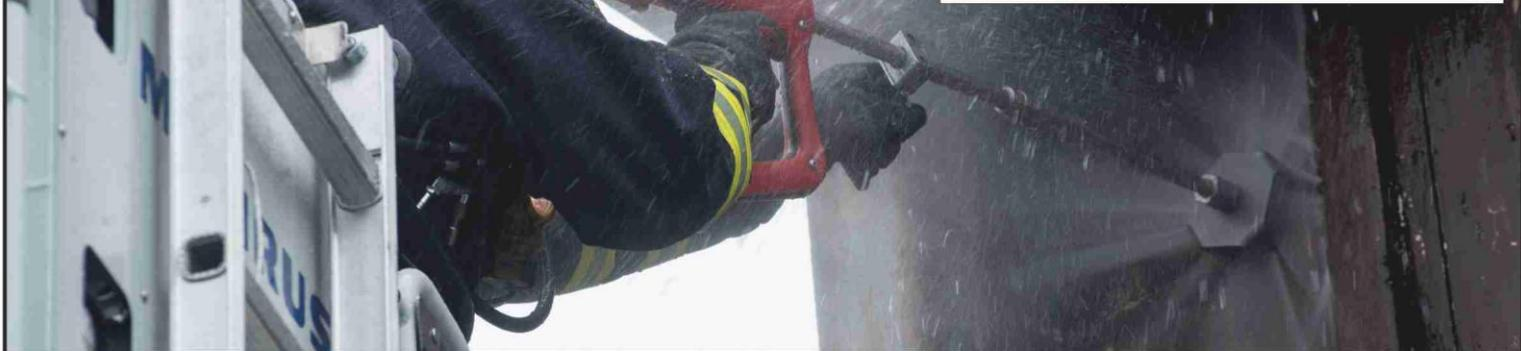
**Pour obtenir le meilleur effet de perçage et avoir toujours un outil maniable avec lequel travailler, il faut ajouter un agent abrasif dans le tuyau d'eau à haute pression. En général, les lances perforantes utilisent deux technologies pour cela : un système de suspension ou un système d'entraînement. Mais quelle est la différence entre ces deux solutions techniques ?**
