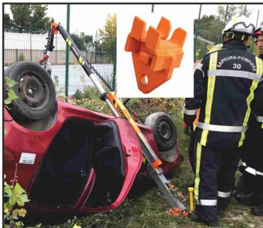
La **TÊTE DARLINGTON** vous permet d'assembler deux étais en reliant les têtes CRG entre elles. Cela permet une mise en place plus facile pour effectuer le Darlington Roll. Elle peut également être utilisée pour mettre en place un Bi Pod en utilisant deux étais. Compatible avec TOUS les étais Res-Q-Jack.
