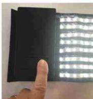
Une pression rapide sur la partie droite ou gauche du commutateur déclenche l'allumage. Plusieurs pressions sur la partie droite permettent d'augmenter le niveau de luminosité.
