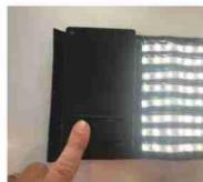
Plusieurs pressions sur la partie gauche permettent de diminuer le niveau de luminosité.
