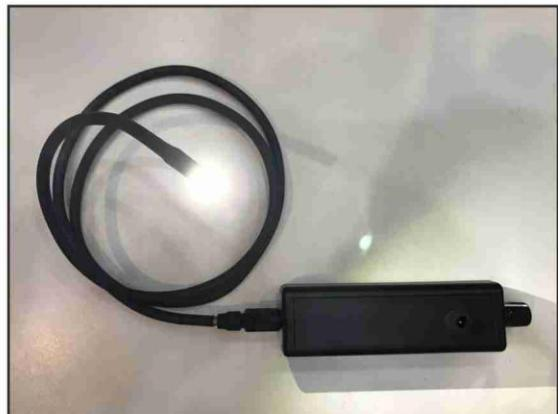
L'EXPLORLAMP : une led de 130 lumens au bout d'un câble semi-rigide de 6 mm de diamètre et 90 cm de longueur.
