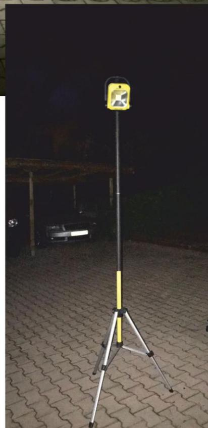
Avec 5 sections vissables la hauteur de l'ensemble est modulable de 0,6 à 3,60 m de hauteur. Le trépied repliable est réglable pour s'adapter aux sols en pente.
