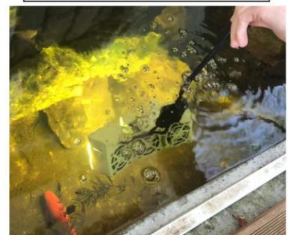
Étanchéité IP67 : les ventilateurs IP68 ici en test permettent la submersibilité de P25 en fonctionnement !
