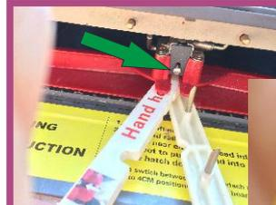
Soulevez la vis centrale du système d'attache avec un doigt...
