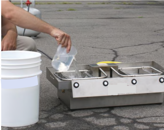
Image 8 : remplissage du bac à feu de l'I.T.S.
