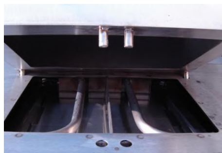
Figure 13: chevilles arrière mises en place
