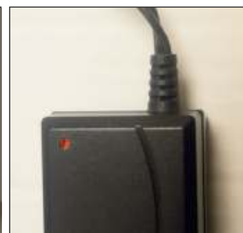
3- Le voyant rouge indique une charge en cours. Il passe au vert quand la charge est terminée.
