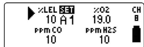
Figure 3.16 : Réglage seuil d'alarme A1
