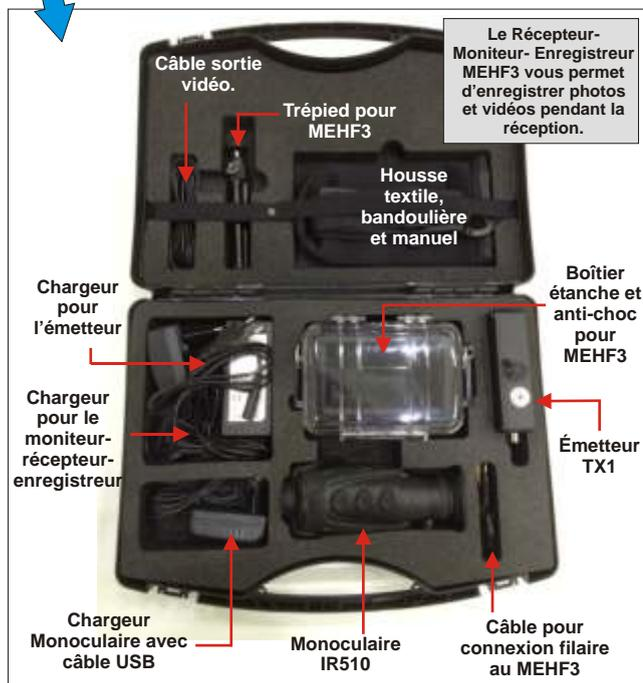
Si une distance de plusieurs dizaines de mètres est nécessaire entre la caméra et le moniteur, un boîtier émetteur TX1 peut-être connecté à la caméra et le moniteur-récepteur MEHF3 reçoit l'image jusqu'à 80 mètres en champ libre.
