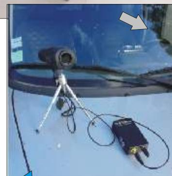
Ci-dessus l'IR510 posé sur un capot de véhicule est connecté à l'émetteur TX1 avec renvoi de l'image sur le MEHF3 que l'on aperçoit à l'intérieur.
